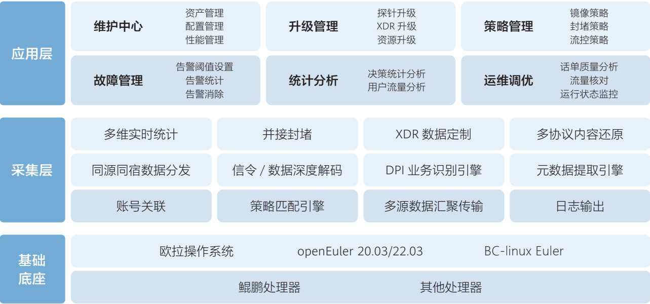
图 4-6 浩智睿一 DPI 采集系统架构图
